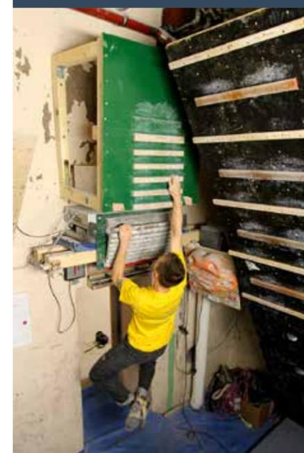
Nicht schön, aber effektiv: der für die Studie eingesetzte Prototyp eines Vibrationsboards, bei dem vibrationsbedingte Muskelkontraktionen (bis zu 2.000 pro Minute) für enorme Trainingsfortschritte sorgten.
